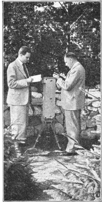
Fig. 4. Geländefähiges Gravimeter nach Thyssen-Schleusener (Gebaut von der Seismos G. m. b. H. Hannover)
