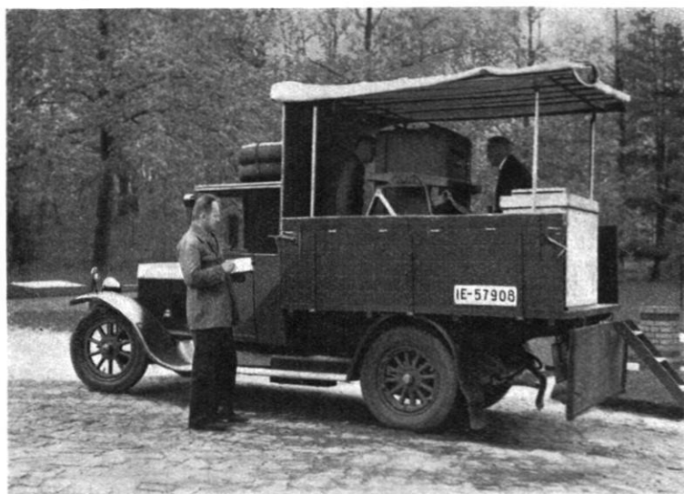
Fig. 2. Messung mit dem statischen Schweremesser im Gelände (Anschlußmessung in Potsdam)
