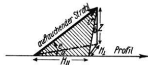
Fig. 2. Der auftauchende Strahl und seine Komponenten. Einfallsebene schraffiert a = Azimutabweichung; e = Emergenzwinkel; b = Basisabweichung; i' = Inzidenzwinkel, gemessen in der Einfallsebene
