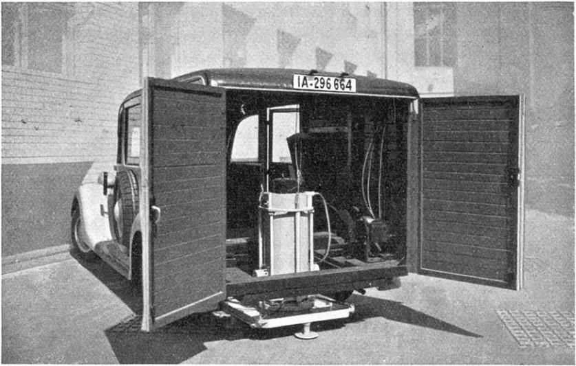
Fig. 12. Das neue Gravimeter in Meßstellung
