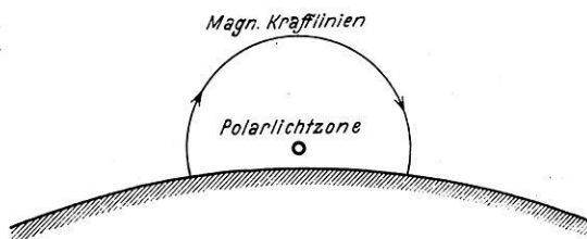
Fig. 1. Vertikaler Schnitt senkrecht zur Polarlichtzone, Blick nach Osten, am Nachmittag eines gestörten Tages. Längs der Zone fließt ein elektrischer Strom nach Osten, also in die Papierebene hinein. Südlich der Nordlichtzone (in der Figur also rechts davon) wird die erdmagnetische Vertikalkomponente Z durch das Magnetfeld dieses Stromes verstärkt
