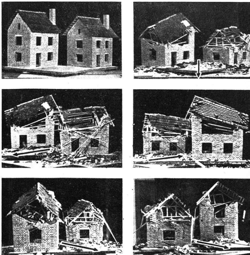
Fig. 7. Zerstörung durch diagonalen Stoß
