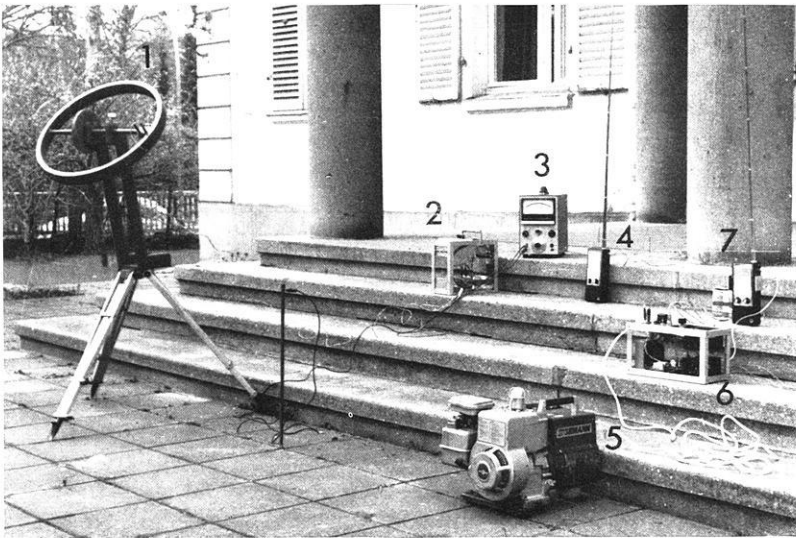
Abb. 2. Die Meßapparatur ohne die Sendespule (1 = Empfangsspule, 2 = Empfangsapparatur mit Verstärker und Phasenmeßeinrichtung, 3 = Elektrometer, 4 = Kurzwellenempfänger, 5 = Benzinaggregat, 6 = Generator, 7 = Kurzwellensender)
