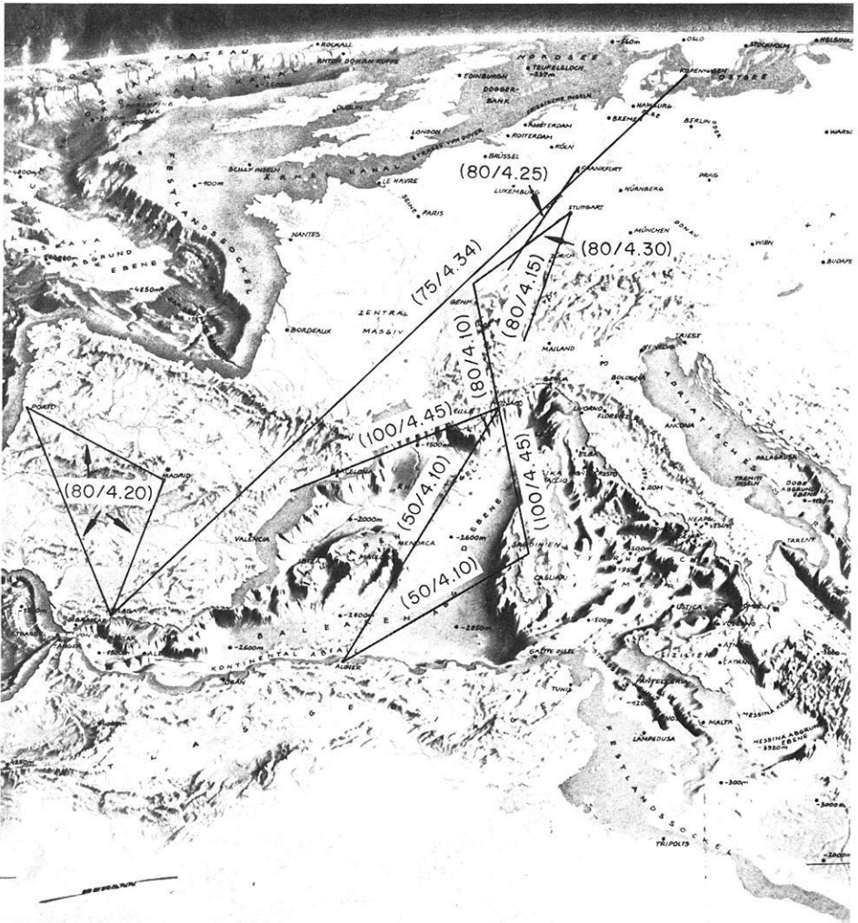
Abb. 15. Zusammenstellung publizierter Ergebnisse von Phasengeschwindigkeitsmessungen nach der Zwei-Stationen-Methode für die Grundmode der Rayleigh-Wellen in Europa (Karte aus der Illustrierten Stern). Die Zahlenpaare bedeuten die Mittelwerte der Lithosphärenmächtigkeit bzw. der mittleren S-Geschwindigkeit im Asthenosphären-Kanal für jede Stationslinie
