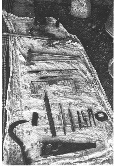
Photo 37: Die Arbeitsgeräte des Siebmachers. Die Werkzeuge dienen zur Aufbereitung des Leders, zur Gestaltung des Holzrahmens und zum Einziehen des ledernen Netzwerkes.
