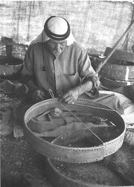
Photo 36: Der Siebmacher (Gharablaji) zieht Lederstreifen in den Holzrahmen ein. Im Hintergrund stapeln sich alte Siebe, die zur Reparatur gebracht wurden.
